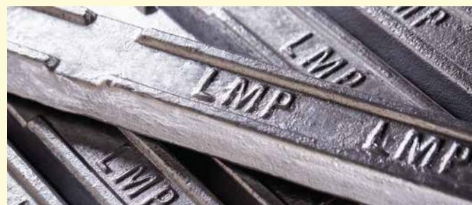
為配合手機行業的最新發展及對新材料的需求，利記擁有豐富經驗的技術團隊研發高強高導熱壓鑄鋁合金的配方，成功做出一種擁有高強度，同時兼備高導熱的壓鑄鋁合金ADC10，其性能相對於ADC12如下：
