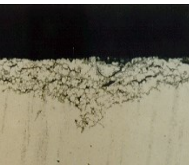
圖 1. 從鑄件的橫截面可以看到晶間腐蝕的狀況
