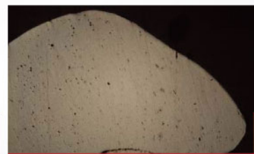
图4: 没有爆裂的锌合金铸件的横截面。
