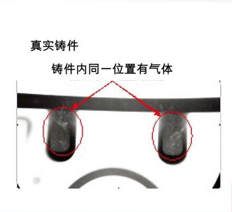
Flow-3D模流分析可以压铸缺陷准确地显现出来，也能帮助工程师在前期阶段就能优化模具设计，在保证产品功能的同时，又能降低生产成本和提高产品的品质！
