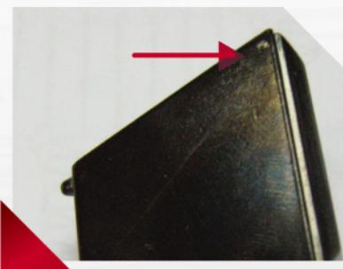
图二：箭咀所示为铸件起泡缺陷的位置
