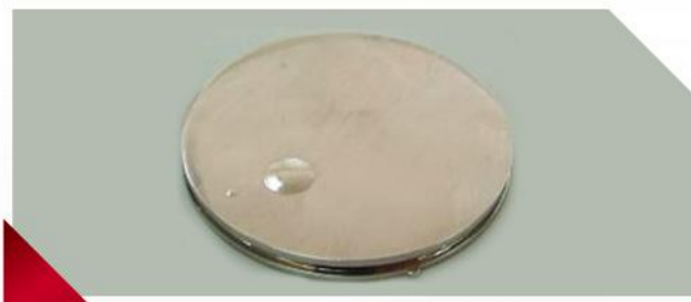
图一：锌合金铸件电镀后起泡
