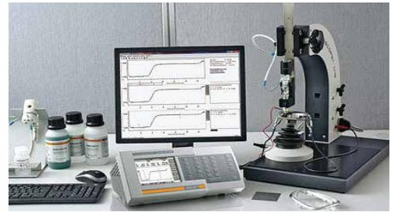
庫倫儀(Couloscope)用於測量電位差，也可測量鍍層厚度(圖片由Fischer提供)
